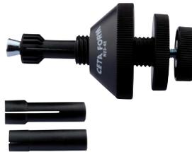
Brüt 5 tona kadar otomobil ve hafif ticari araçlar için, debriyaj balatasının, baskı balatasına doğru şekilde merkezlenmesi ve montajı için özel alet, plastik gövde, metal vida, 3 adet mandren ile birlikte sunulur
