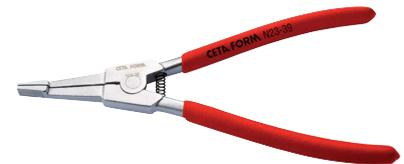
Kardan millerinde ve vites kutularında bulunan dış kör segmanlar için, tırtırlı uçlar, Krom Vanadyum çeliği, mat krom kaplı yüzey, PVC daldırma sap
