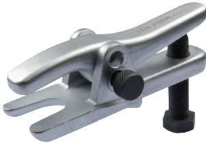
Rot kolu ve stabilizörler gibi yürüyen aksam elemanları üzerinde bulunan rotillerin sökümünde kullanılır, özellikle Alman araçları için, dövülmüş Krom-Vanadyum çeliği, mat krom kaplı gövde
