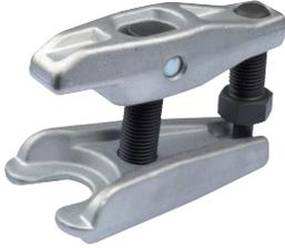
Otomobil ve hafif ticari araçların rotillerinin sökülmesi için, rot kolu ve stabilizörler gibi yürüyen aksam elemanları üzerinde bulunan rotillerin sökümünde kullanılır, dövülmüş Krom-Vanadyum çeliği, mat krom kaplı gövde
