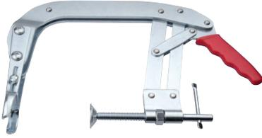
Subap değişimi esnasında motor subap yaylarının sıkıştırılmasında kullanılır, çoğu küçük ve orta ölçekli OHV motorlar için, otomatik kilitlemeli, paralel çekimli tasarım
