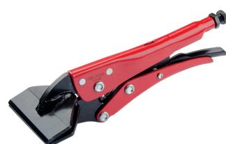
Düz parçaları güvenli kavrama ve sıkıştmak için, Krom Vanadyum çeliği 80 mm genişliğinde çeneler, epoksi kaplı, yüksek mukavemetli çelik sac sap,
