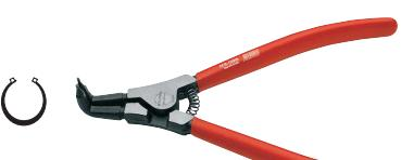
Mil (Şaft) üzerindeki dış emniyet segmanları için, 90° eğik çeneli uçlar, açma yaylı, Krom Vanadyum çeliği, elektro vernik kaplı polisajlı yüzey, PVC daldırma sap
