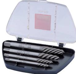
Kırılmış civata ve vidaların sökülmü için, özel sol helisli kılavuz takımı, Krom Molibden çeliği
